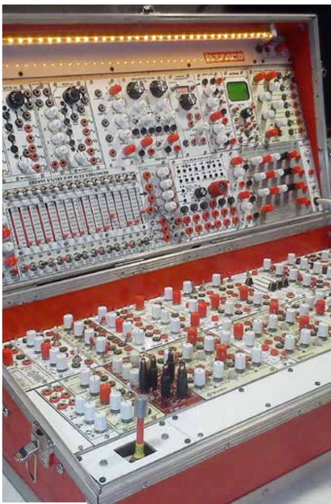
Vista general d'un sintetitzador modular construït gairebé en la seva totalitat amb mòduls de Befaco
